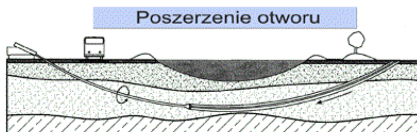
Rys. rozwiercenie, poszerzenie i stabilizacja otworu
