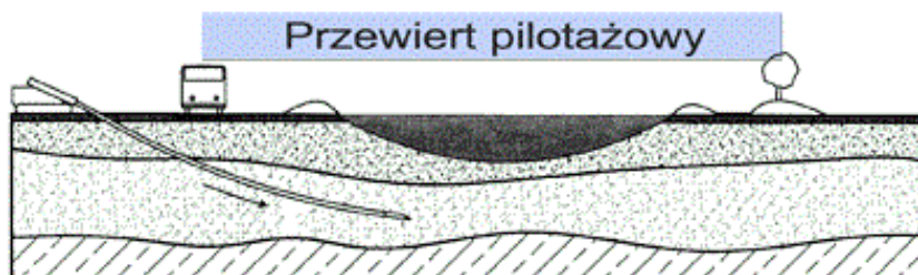
Rys. wykonanie przewiertu pilotażowego z możliwością jego sterowania.
